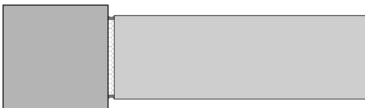
Fig. 15, corte horizontal muro/pilar, junta de dilatación rellena con poliestireno expandido conformando una junta rehundida terminada con sellador poliuretánico, el acuñaado se resuelve de modo similar, pudiendo variar el espesor de la junta.
