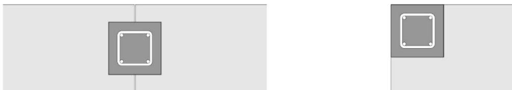
Fig. 11, corte horizontal, pilar de traba calado en el bloque, pasa a la cara interior para amurar las aberturas que llegan al piso
