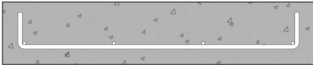
Fig. 7, corte vertical, zapata corrida bajo murete, va armada con 4 hierros longitudinales \phi 6 + transversales \phi 8 c/20cm
